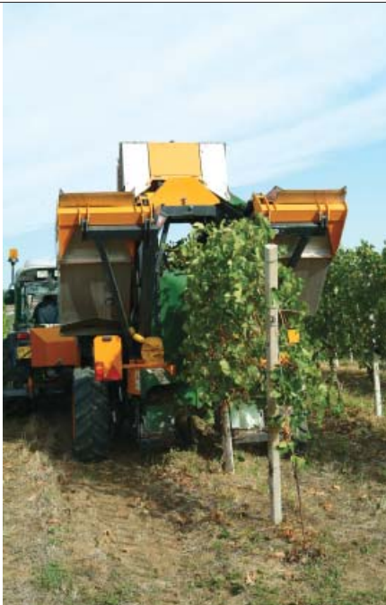
Vendemmiatrice trainata al lavoro su impianto con palificazione in cemento.
