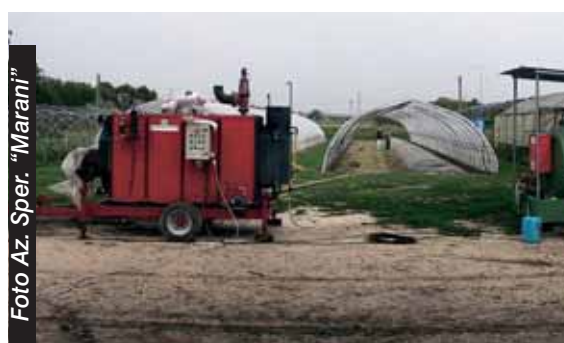
Attrezzatura utilizzata per la disinfezione a vapore presso l'azienda "M. Marani" di Ravenna.
